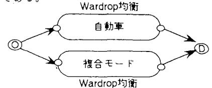
モデル③：このモデルではまず最初にロジットを用いて乗り換え点の選択を行い、次に機関分担をするという2段階の手順を行う。従ってネットワードロジットを交通均衡配分と組み合わせたようなモデルとなる。乗り換えに要する時間
