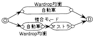
モデル④：このモデルでは、複合交通手段をも含めたすべての自動車ネットワークの配分を確率均衡配分 (Dial法) を用いて行う。モデル①では完全情報下での経路配分をしているのに対し、このモデルでは不完全情報下での経路配分をしているため、モデル①とは全く対称的な考え方をしている。
