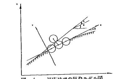
図-4 河床波での反発モデル図
