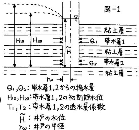
各帶水層の初期静水位は、揚水井戸の合成静水位より、それぞれ 0.1 m (A 帯水層), 0.45 m (B 帯水層) 高い位置にあることもわかっている。(7)式にもとづいて  $t_A$  と  $t_B$  に関する方程式が次のように得られた。
