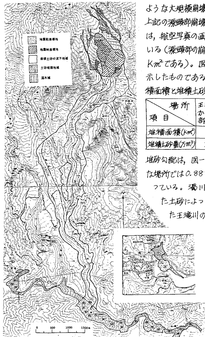
図-1 位置図(崩壊、流下、堆積の状況)
