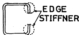
Fig.1 リップみぞ形鋼の端補剛材
