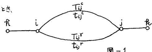
$$T_{ij}^r = \kappa K_{ij} G_i^\alpha A_j^\beta t_{ij}^{-r} (1 - y_{ij}) \quad (2)$$
