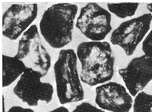
図-3. 標準砂の顕微鏡写真, 297μフルイをパスし、210μフルイに残留のもの。
