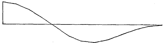
図2 起拱梁の曲げモーメント影響線
