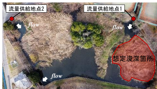
図2 流量供給地点および想定浚渫箇所
