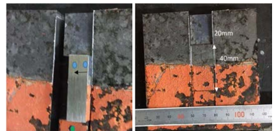
写真-1 加工した供試体
