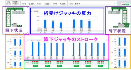
降下ジャッキの反力 反力ピンの抜差し状況 降下ジャッキの反力
