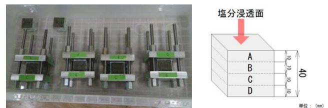
図-1 塩水浸せき試験 図-2 分析サンプル
