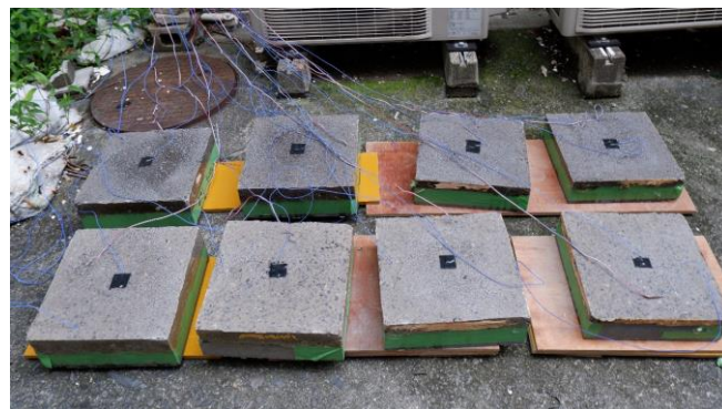
写真-1 夏季屋外暴露測定状況
