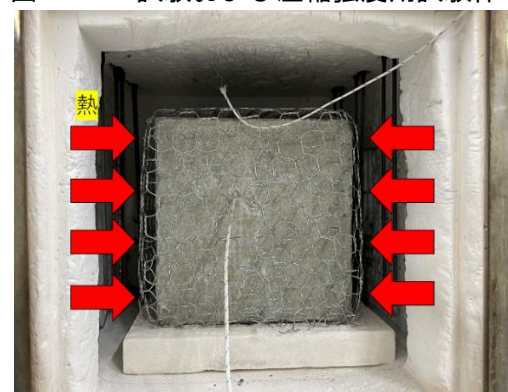
図 3 爆裂による炉内破損防止の様子
