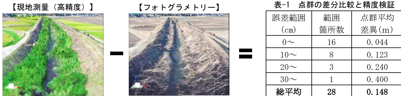
図-3 現地測量とフォトグラメトリーの点群データの差分比による精度検証
