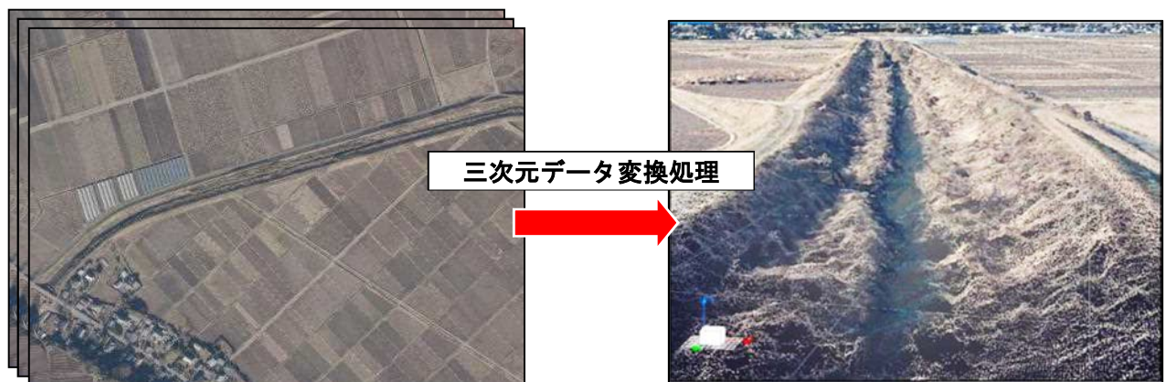
図-1 左の航空測量写真を複数枚重ね合わせ、AI画像解析・差分計算機能を備えた専用ソフトにより右の三次元点群データへ変換(以下、「フォトグラメトリー点群データ」という)
