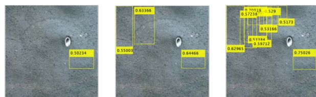
図3 SSDオブジェクト検出器によるひび割れの検出結果の一例
