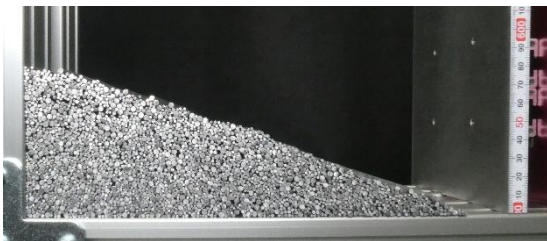
(a) アルミ棒積層体を用いた安息角試験
