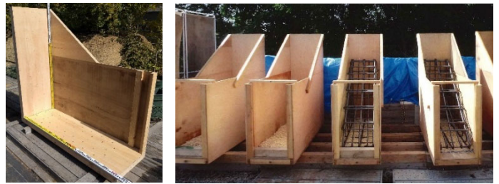
図-1 実験③の土槽(鹿沼土・鉄筋枠設置)
