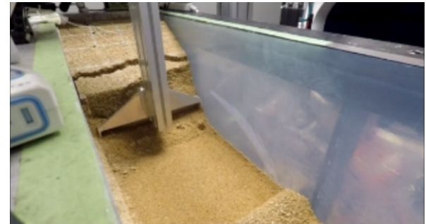
写真-2 第2崩壊後の斜面 (9146sec)
