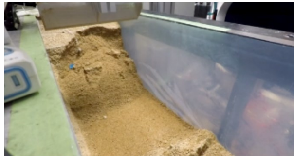
写真-3 第3崩壊後の斜面 (11889sec)
