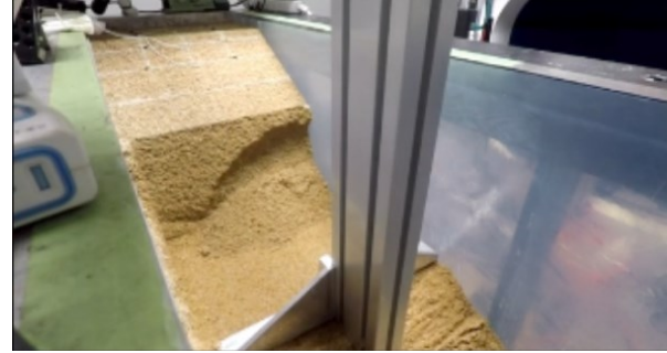
写真-1 第1崩壊後の斜面 (6866sec)
