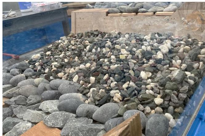
写真 1 砕石土台の設置状況
