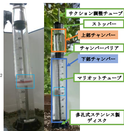
写真-1(左)フロート、(右)構造図
