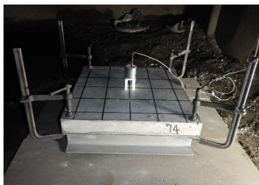
図-1 コンクリート板の設置状況
