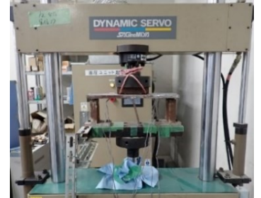
図 2 4 点曲げ疲労試験
