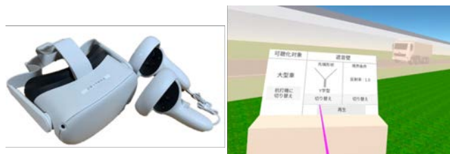
図-4 HMDによる交通騒音シミュレーションシステム
