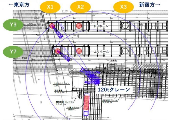
図-4 鉄筋籠投入手順
