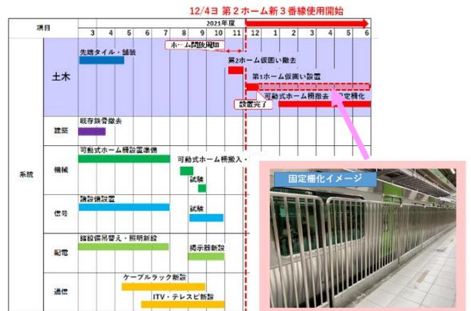
図2 ホーム切換までの各システムの作業工程
