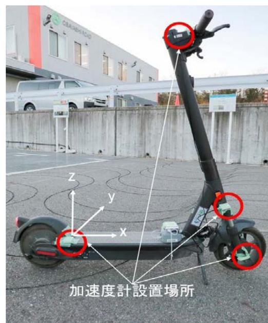
図-2 計測に使用した電動キックボード
