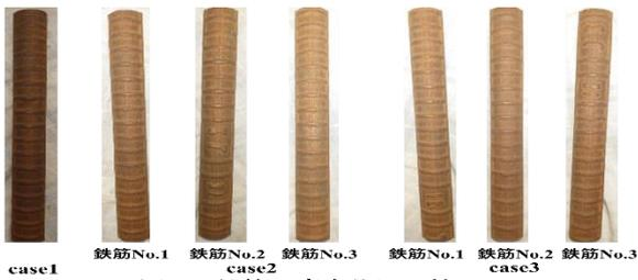
図-5 鉄筋の腐食状況比較
