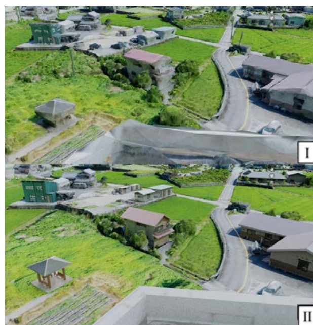
図-5 モデルの比較 I: ドローンデータ, II: 本手法
