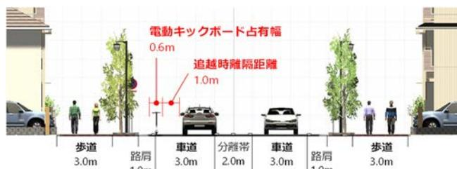
図2 VR 走行実験で用いた道路の横断構成
