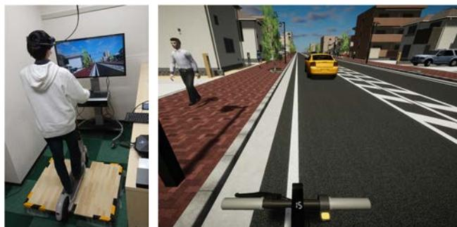
図1 電動キックボードVRシミュレータ(左)と被験者が体験する映像イメージ(右)
