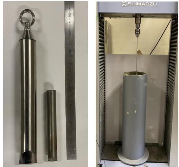
写真2 重錘の縮尺模型
