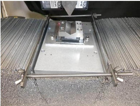
図-2 シートパイル固定部拡大写真
