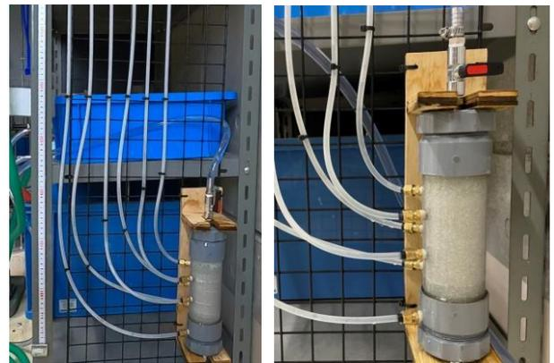
図 2 透水・流出試験装置
