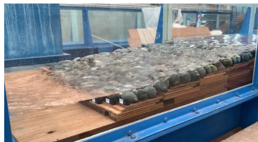
写真2 粗礫斜路上の流況 (Case2)
