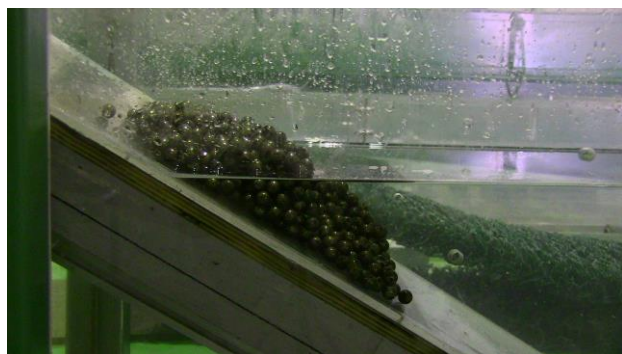
図-3 鉄球 10mm を積載した様子
