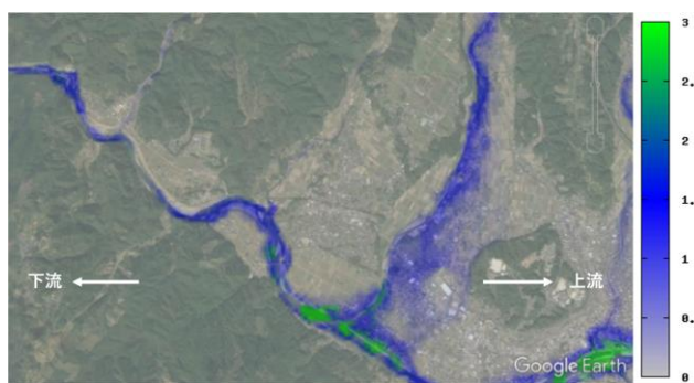
図-2 球磨川上流域（津波洪水が発生した地点）での氾濫解析結果（30mメッシュ、7月4日16時半ごろ）
