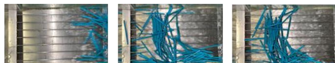
写真-3 流下過程 (捕捉工間隔 30 mm, 流木 100 本)
