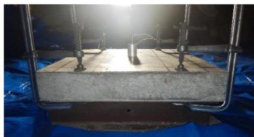
図-1 コンクリート板の設置状態
