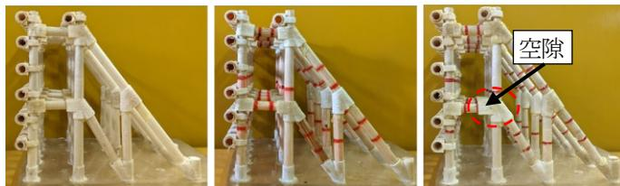
(a) 母材強度比 100% (b) 母材強度比 70% (c) 押し込み変形
