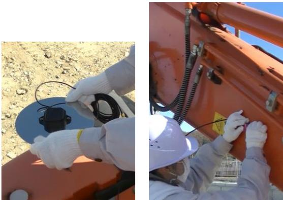
図3 GNSS アンテナ・角度センサー取り付け
