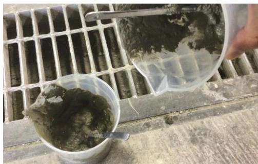
図-1 ゲル化後の試験体の写真
