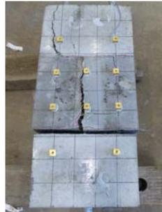
図-2-b TypeB 破壊形状
