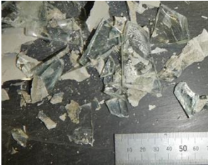
図-4 ガラス板の破壊
