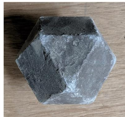
写真-1 立方八面体の鋼製重錘
