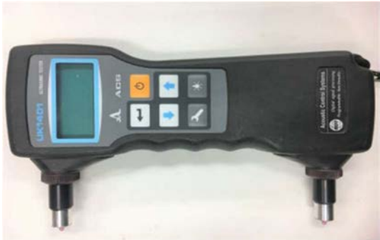
図-1 使用した超音波速度測定装置 表-1 コンクリートの計画配合
