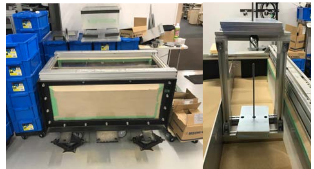
図-2 左図:使用土槽 右図:直接基礎橋脚重ねて設置した。
