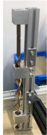
写真-4 杭打設治具
