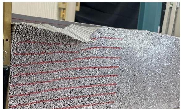
図-2 アルミ棒が面外にせり出した様子
