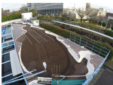
写真-2 実験前の河床 (左: 下流側造成案、右: 上流側造成案、点線部は流路の造成部)
