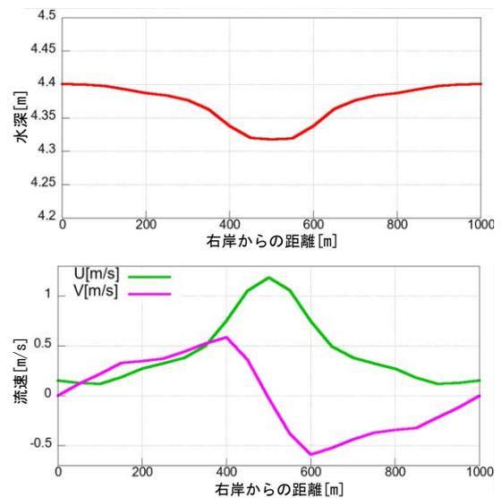
図-3(a) (Case-1) LC=50m の場合の横断面での水深と流速 (I断面から上流側に 50m)
