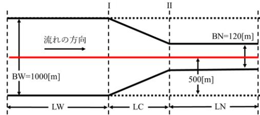
図-1(a) 河道平面図と記号の定義 (Case-1)
